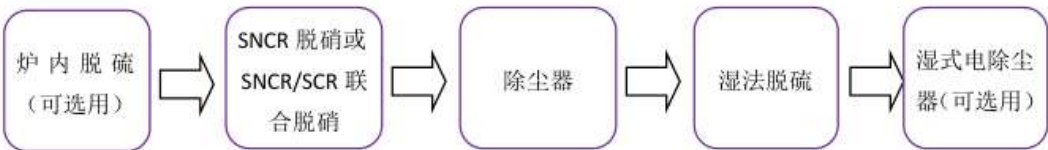
图 2 超低排放工艺流程 2（循环流化床锅炉）
